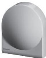
25 °C de NTC 1000 ohm olarak dış hava sıcaklığını tespit ederek değeri kazan elektronik panosuna ileter. Direkt olarak kazan kontrol panosuna bağlanır
