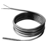
Ntc 10 k daldırma tip sensördür. Boyler, akış ve zone sensörü olarak kullanılır. Direkt olarak kazan kontrol panosuna bağlanır. Maksimum 120 m. ( $1,5 \text{ mm}^2$  kablo kesiti) Maksimum 80 m. ( $1 \text{ mm}^2$  kablo kesiti) maksimum 40 m. ( $0,5 \text{ mm}^2$  kablo kesiti)
